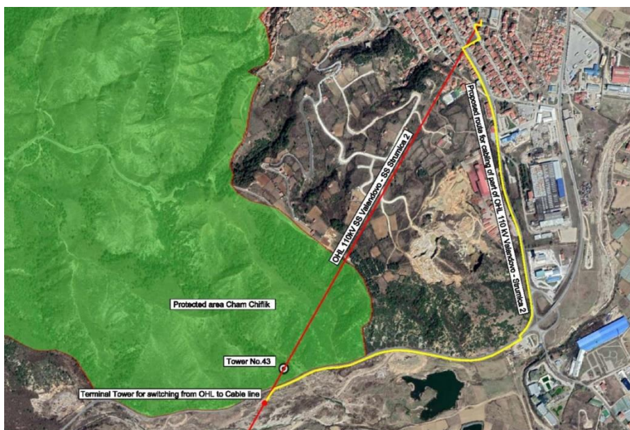
Слика 3.4: 110 kV преносен кабел до трансформаторската станица Струмица 2
